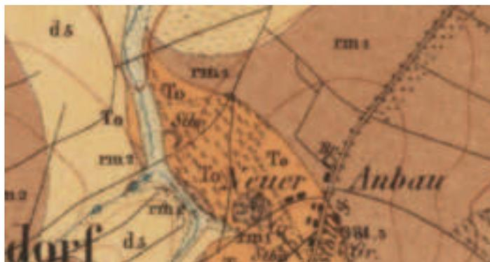
Die geologische Spezialkarte von 1907 zeigt ein in etwa kreisrundes Abbaugebiet im Bereich „Neuer Anbau“, links der Stollberger Straße. Darunter etwas schwer zu erkennen die Abkürzung „Stbr“ für Steinbruch. Die Abkürzung „To“ steht für Oberer Porphyrtuff. Karten als Reprint im Bestand Norbert Engst
